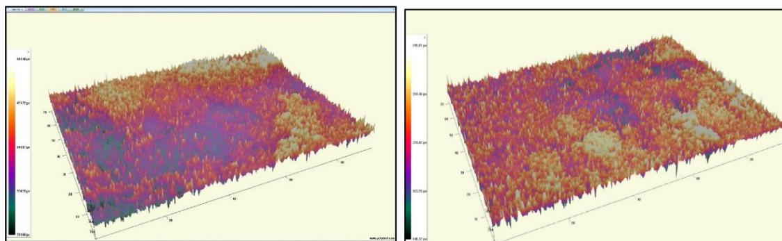
TCL -ZnO Np: Ra(nm) :19.14, Rq(nm):23.03    ZCL -ZnO Np: Ra(nm) :34.77, Rq(nm):44.24
